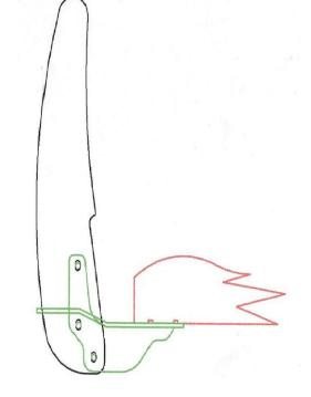
INSTALL GRILLE GUARD WITH MOUNTS TO THE INSIDE OF THE GUARD UPRIGHTS.
